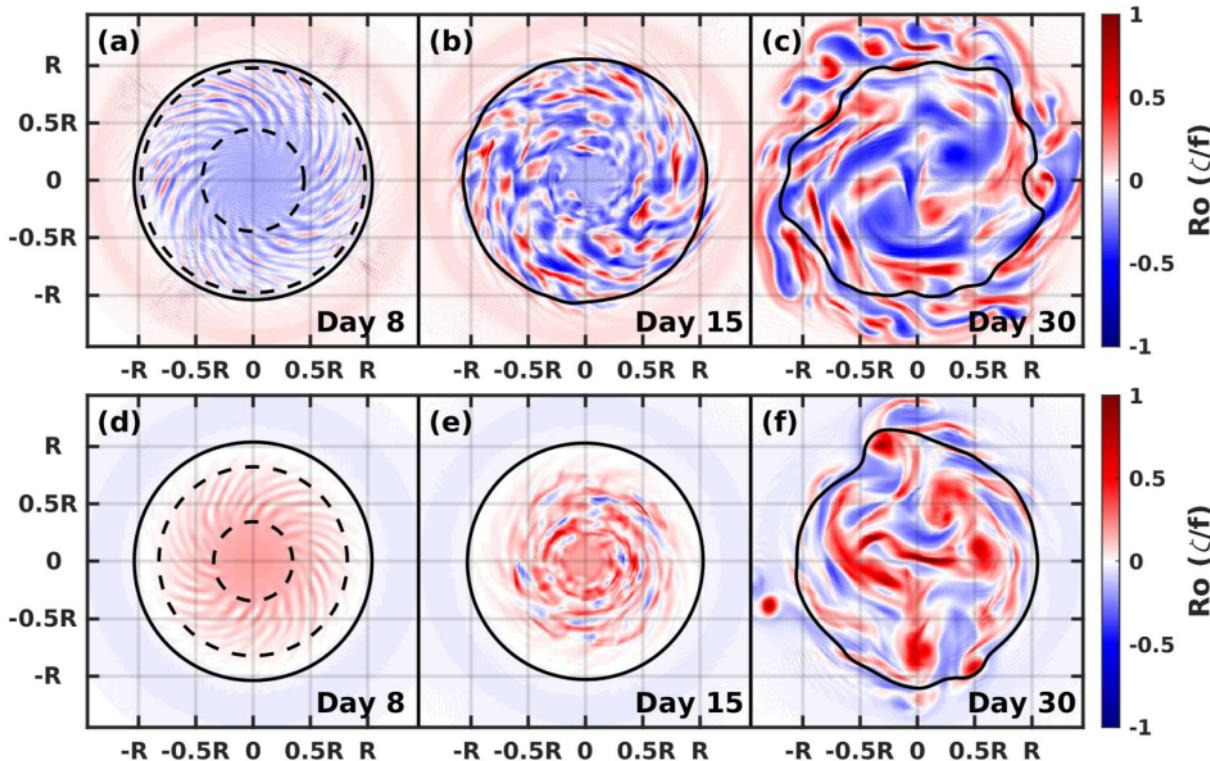
反气旋涡（上）与气旋涡（下）内不同时段的相对涡度空间分布，体现亚中尺度涡丝的不同演化特征
